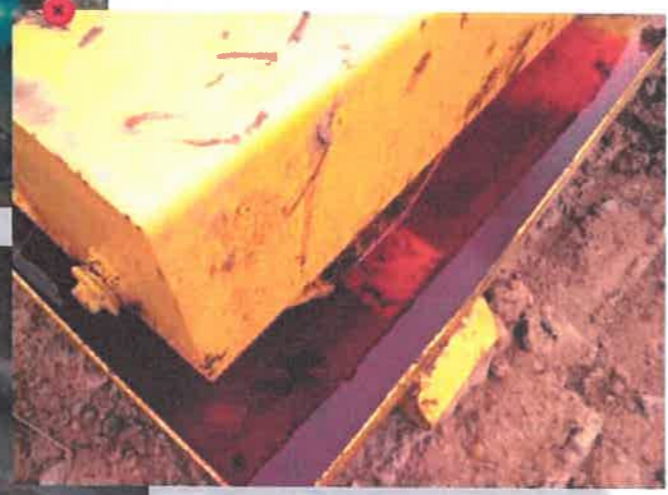
Les pompes ou groupes doivent de préférence être protégés contre les intempéries. À défaut, ils sont équipés d'un bac de surverse qui doit être surveillé et vidé régulièrement.
